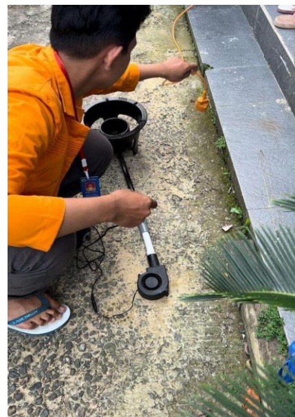
Gambar 4. Merancang Kompor Oli Bekas dan Minyak Jelantah
