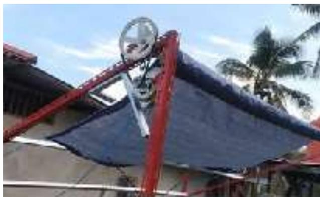
**Gambar 10. Atap Otomatis sebagai Pelindung Buah Naga dari Cuaca dengan Curah Hujan Tinggi**
