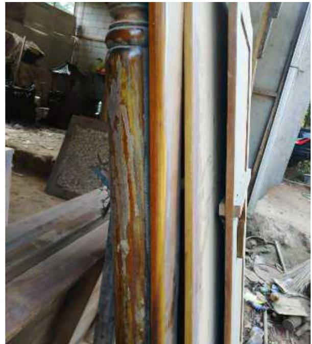
Gambar 2. Penampakan produk mebel yang cacat *finishing* karena jamur
