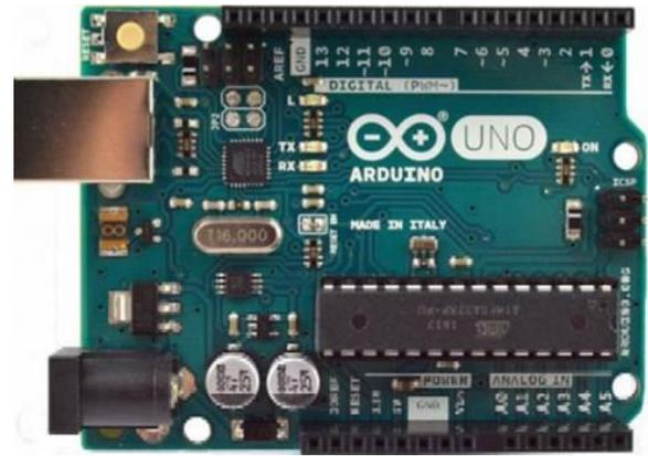
Gambar 5. Mikrokontroler Arduino Uno
