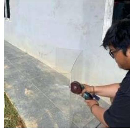
Gambar 2. Proses Pemotongan Papan Akrilik
