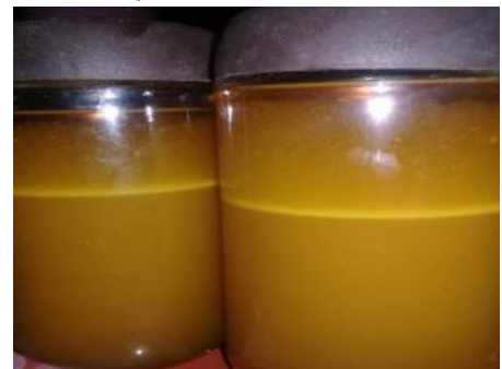
Gambar 7. Minyak jelantah yang telah bercampur methanol dan NaOH.
