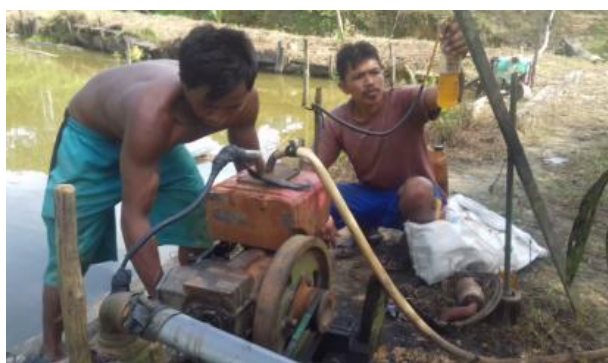
Gambar 9. Hasil uji coba biodiesel pada mesin dompok
